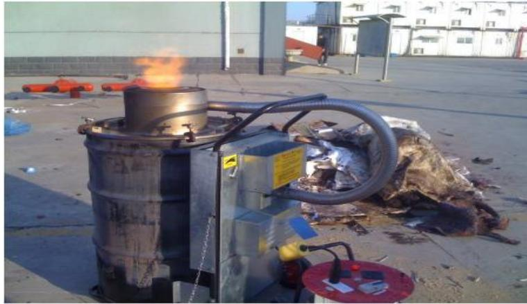
图 B-27 便携式多用途焚化炉示意图
