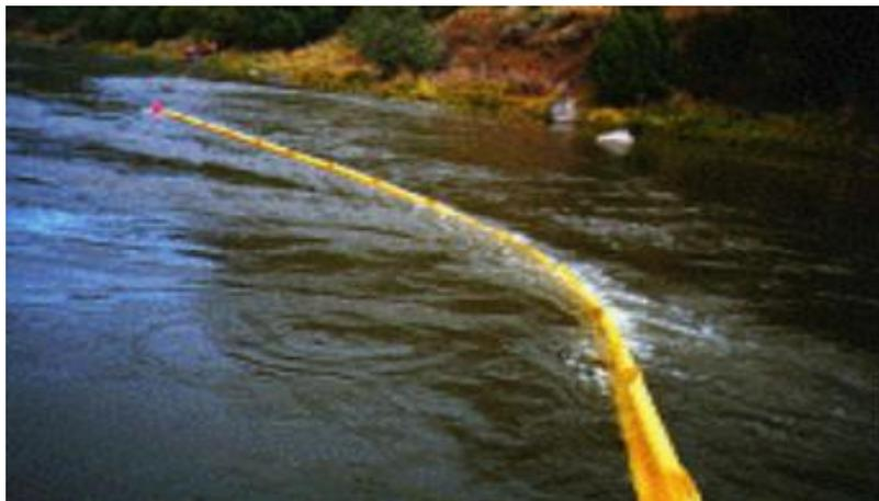
图 B-18 激流型围油栏
