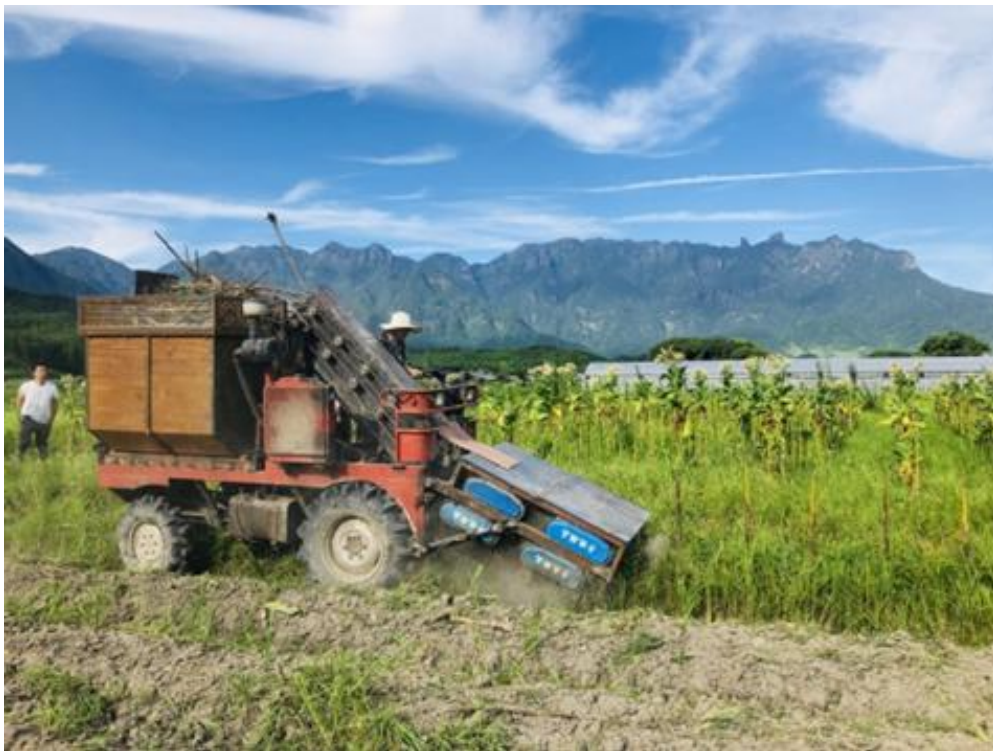
图 5-17 拔秆机拔秆作业
