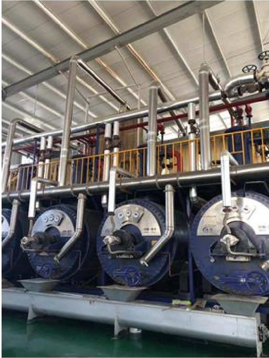
图 5-12 鸡羽毛水解加热制蛋白粉设备
